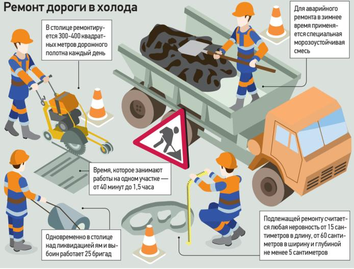
Ремонт дороги в холода. В столице ремонтируется 300-400 квадратных метров дорожного полотна каждый день. Для аварийного ремонта в зимнее время применяется специальная морозостойкая смесь. Одновременно в столице над ливневидящей ямой и выбоиной работает 25 бригад. Подлежащей ремонту считается любая неровность от 15 сантиметров в длину и от 60 сантиметров в ширину и глубиной не менее 5 сантиметров. Время, которое занимают работы на одном участке — от 40 минут до 1,5 часа.
