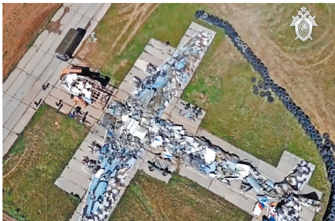
Чтобы понять, куда попала ракета, пришлось «сложить» борт из обломков.
