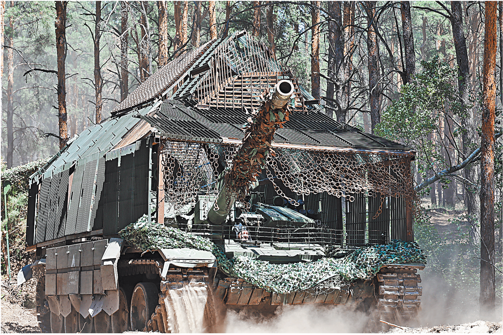
В российских войсках появились танки Т-72 с усиленной противоракетной защитой типа «дикообраз». Такая конструкция выдерживает попадание беспилотника и сохраняет экипаж.
