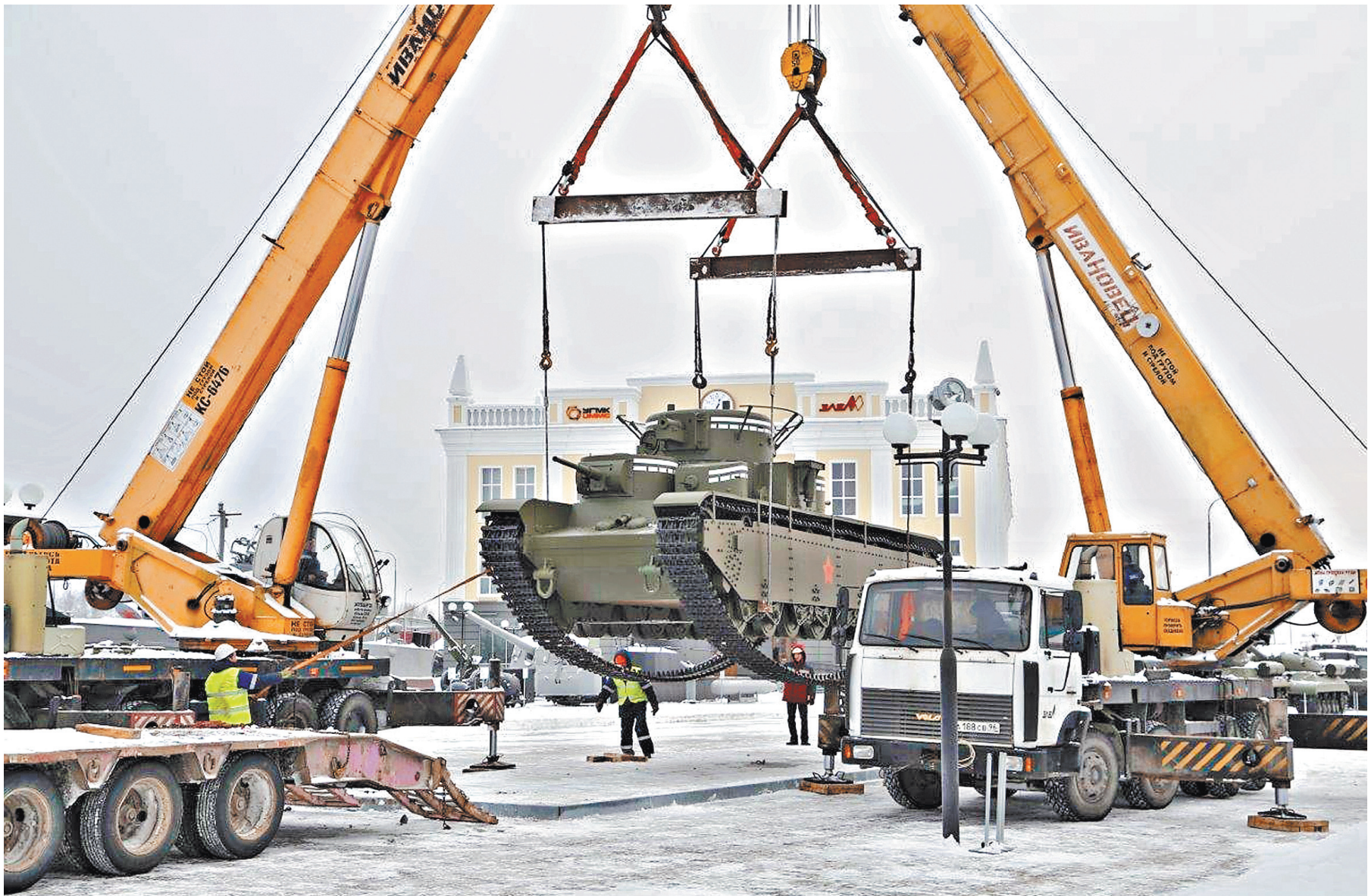
Уральские металлурги по оригинальным чертежам воссоздали пятибашенный танк Т-35 30-х годов XX века. Над точной копией машины — от оригинала она отличается только тем, что не имеет двигателя, — трудились десять рабочих и инженеров в течение полугода. Всего они изготовили более тысячи деталей. Редчайший танк — всего было изготовлено 59 экземпляров боевой машины — пополнил музей уральской металлургической компании, коллекция которого насчитывает более 200 единиц военной техники и раритетных авт.
