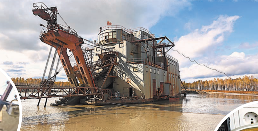
Это раньше золотодобытчики намывали золото вручную. Сейчас для этого применяют драги (на фото) – комплексно-механизированный горно-обогатительный агрегат. Сами рабочие золото не трогают. А вставить золотые коронки могут, только купив их на честно заработанные рубли.
