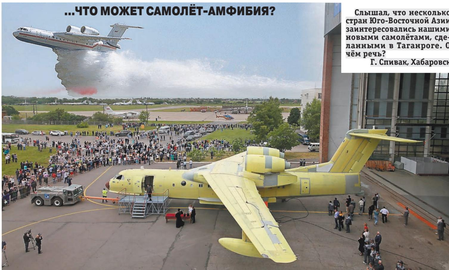
Речь идёт о самолёте-амфибии Бе-200ЧС, который практически полностью построен из отечественных комплектующих. Предназначен он для тушения пожаров, оказания экстренной помощи в районах чрезвычайных бедствий и т. д. Такой самолёт может взять на борт до 12 тонн воды и от 30 до 50 пострадавших.
